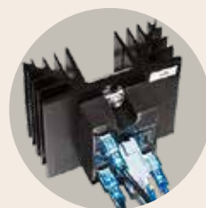
Geruisarme en snelle schakeling van de verwarming via halfgeleiderrelais
