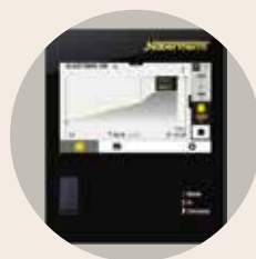
Controller met touch-bediening C540 met 10 programma's met elk 20 segmenten
